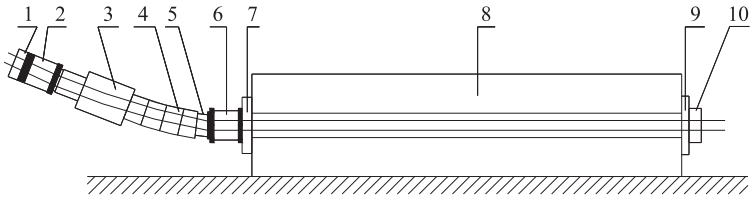
图 C.3.2 变角张拉摩擦损失测试装置
