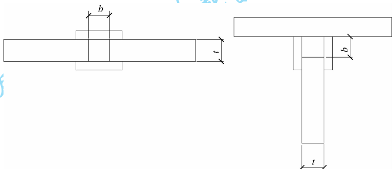
图 8.3.7-2 电渣焊接头坡口示意
