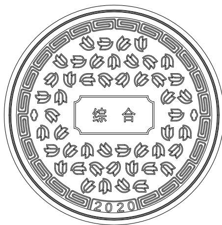
图 4.4.6 圆形球墨铸铁井盖
