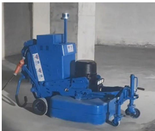
图5.20 地坪研磨机器人
