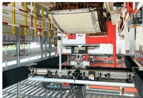
图 5.11 智能管片抹平机器人
