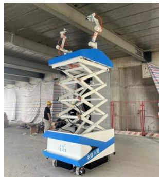
图 5.19 钢梁防火喷涂机器人
