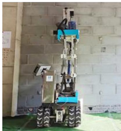
图 5.21 墙面开槽机器人
