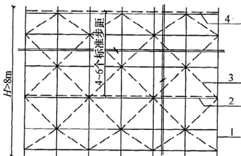
图 6.1.3-3 满堂架高度大于 8m 水平斜杆设置立面图
