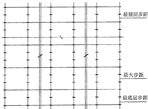
图1 减小最顶（底）层步距示意
