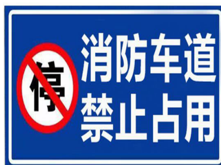
图 4.2.11-3 消防车通道禁止占用 警示牌示例图
